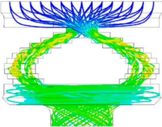
**2. Die Hochgeschwindigkeits-Wirbelung**, bei der das Wasser in einer genau definierten und exakt gefertigten Wirbelkammer extrem beschleunigt wird.
