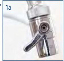
Dieses Nachlaufen wird reduziert, wenn nach dem Abstellen des Wasserhahns der Hebel am Umlenkenventil halb zwischen die waagerechte und die senkrechte Position gestellt wird (Bild 1a).
